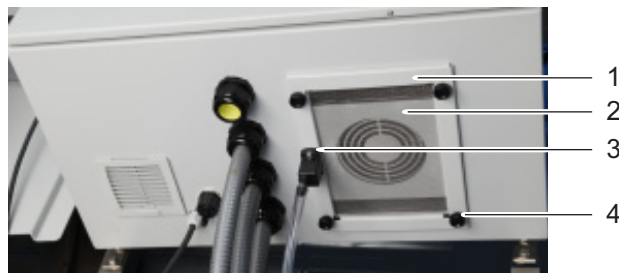
figura 3-18 Vaglio bug e adattatore di drenaggio della condensa montati
