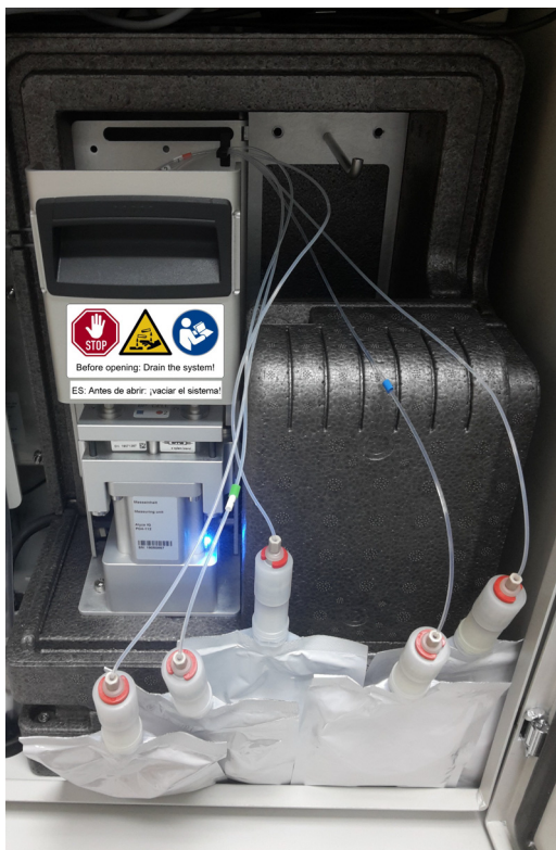
figura 5-7 ChemBag rimossa per la sostituzione
