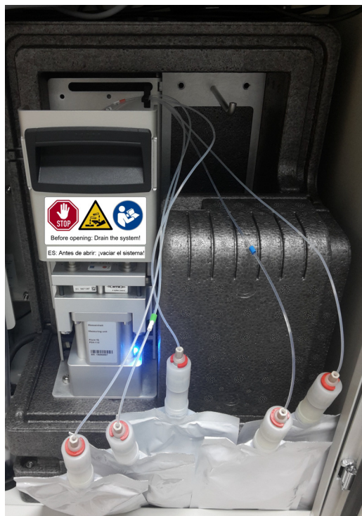
figura 5-19 ChemBag rimosse dall'asta di supporto
