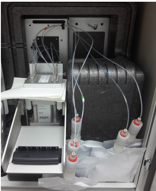
figura 5-20 Carta assorbente nel ricettacolo della valvola MultiPort
